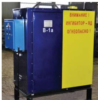
**Установка дозировочная УДЭ** предназначена для дозированного ввода жидкых деэмульгаторов и ингибиторов парафиноотложения, солеотложения, коррозии (в дальнейшем – реагентов) в трубопровод промысловой системы транспорта и подготовки нефти с целью осуществления внутритрубопроводной деэмульсации нефти, а также защиты трубопроводов и оборудования от парафиноотложения, солеотложения и коррозии.
